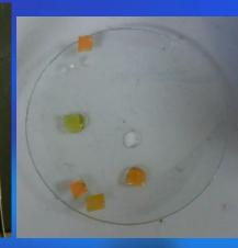
■ pH試紙撕成小塊放於表 玻璃上,每次檢測時夾 一小塊置於玻璃管柱下 方
