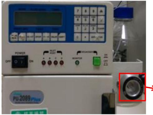
將針插入注射口,注射後開始分析 (先轉至LOAD,再插到底,然後注 射,之後轉至INJECT再把針拉出來)
