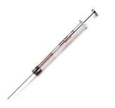
使用HPLC的針(確認是HPLC的針,體積為50µl) 每次取25µl樣品(取樣品前,用蒸餾水潤洗數次;取樣品時,也先潤洗數次,排除殘留的水,並小心地排出氣泡)
